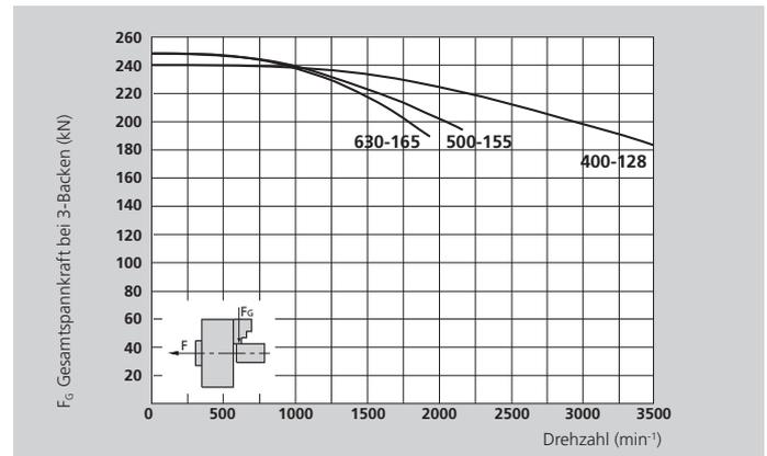
Die Daten des Diagramms beziehen sich auf 3-Backenfutter, die nach Bedienungsanleitung frisch gewartet und mit SMW-AUTOBLOK-Fett K05 geschmiert sind. Die statischen und dynamischen Spannkräfte sind mit weichen Standard-Aufsatzbacken gemessen, die nicht radial über den Futterkörper überstehen.
