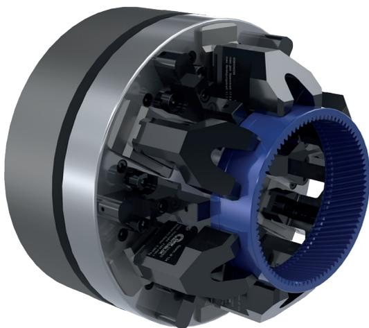
● **Kundenanforderung:** Deformationsarme Spannung von Innenzahnradern auf einem SJL 6-Backen Spannfutter, max. Rundheitsfehler: 0,020 mm.
