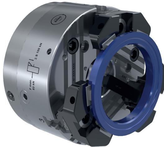
**Kundenanforderung:** Deformationsarme Spannung mehrerer, im Durchmesser unterschiedlicher, verformungsempfindlicher Stahlringe. Spannbereich: 120 - 205 mm, der gesamte Spannbereich soll mit max. 2 Satz Spanneinsätze abgedeckt werden. Zulässiger Rundheitsfehler: 0,03 mm.
